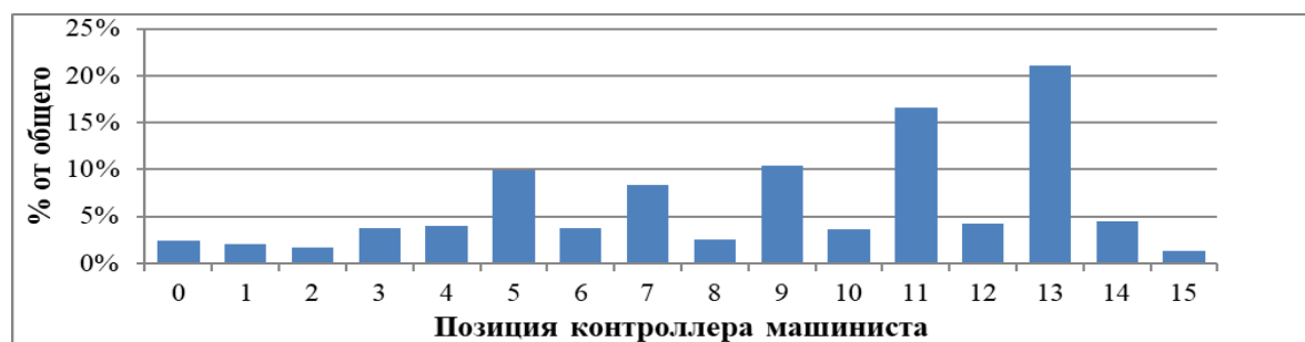
Рисунок 4 – Распределение расхода топлива по позициям контроллера
